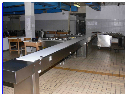
Pásový dopravník pri dávkovaní stravy
